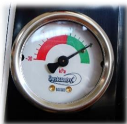
Manometro che indica quando pulire i filtri
